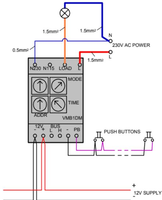
*Direkte Bedienung mit Drucktastensteuerung und Steuerung über VELBUS :*
