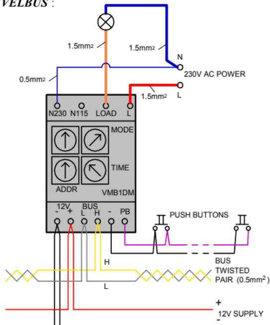
(\*) **Bemerkung:** Stellen Sie die Adresse auf '00' um die Kommunikation mit dem VELBUS-System aus zu schalten. Löschen Sie auch alle "gelehrten" Drucktasten. Wenn das nicht geschieht, dann wird das Dimmermodul bei jeder Zustandsänderung einen Busfehler verursachen.
