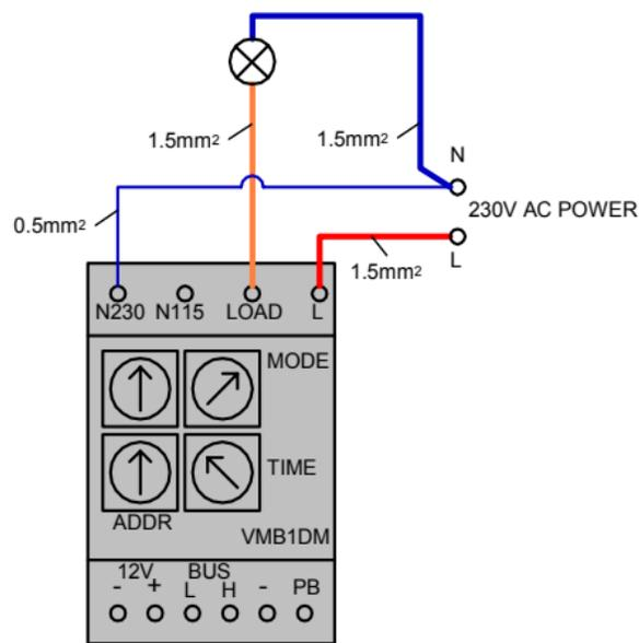
**Attention** : Placez l'interrupteur rotatif sur une des positions suivantes : 0, 1, 2, 3, 4, 5, 6 ou 7.
