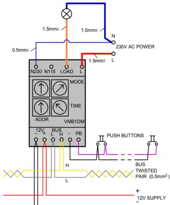
(\* **Observación:** Para cortar la comunicación con el sistema VELBUS, ponga la dirección en '00'. Borre también todos los pulsadores aprendidos. Si no es el caso, el módulo dimmer causará un error de bus.
