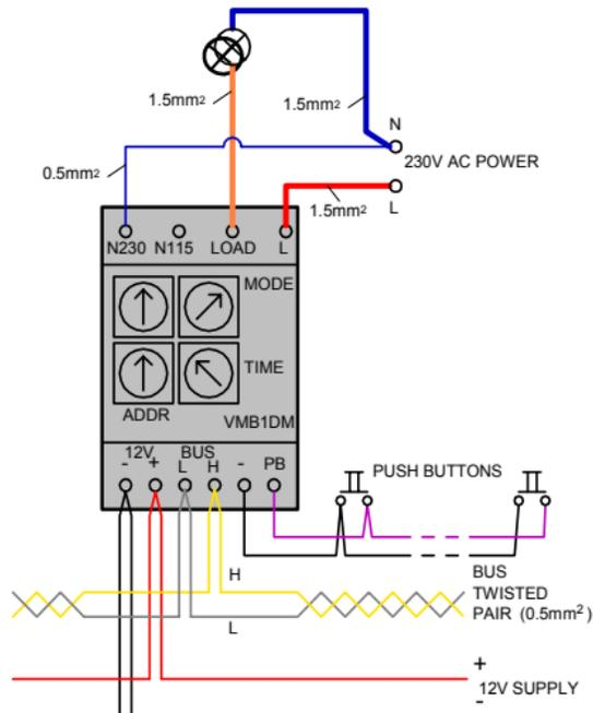
(\*)**Opmerking:** Plaats het adres op '00' om de communicatie met het VELBUS-systeem uit te schakelen. Wis ook alle aangeleerde drukknoppen. Gebeurt dit niet, dan zal de dimmermodule een busfout veroorzaken bij iedere toestandswijziging.
